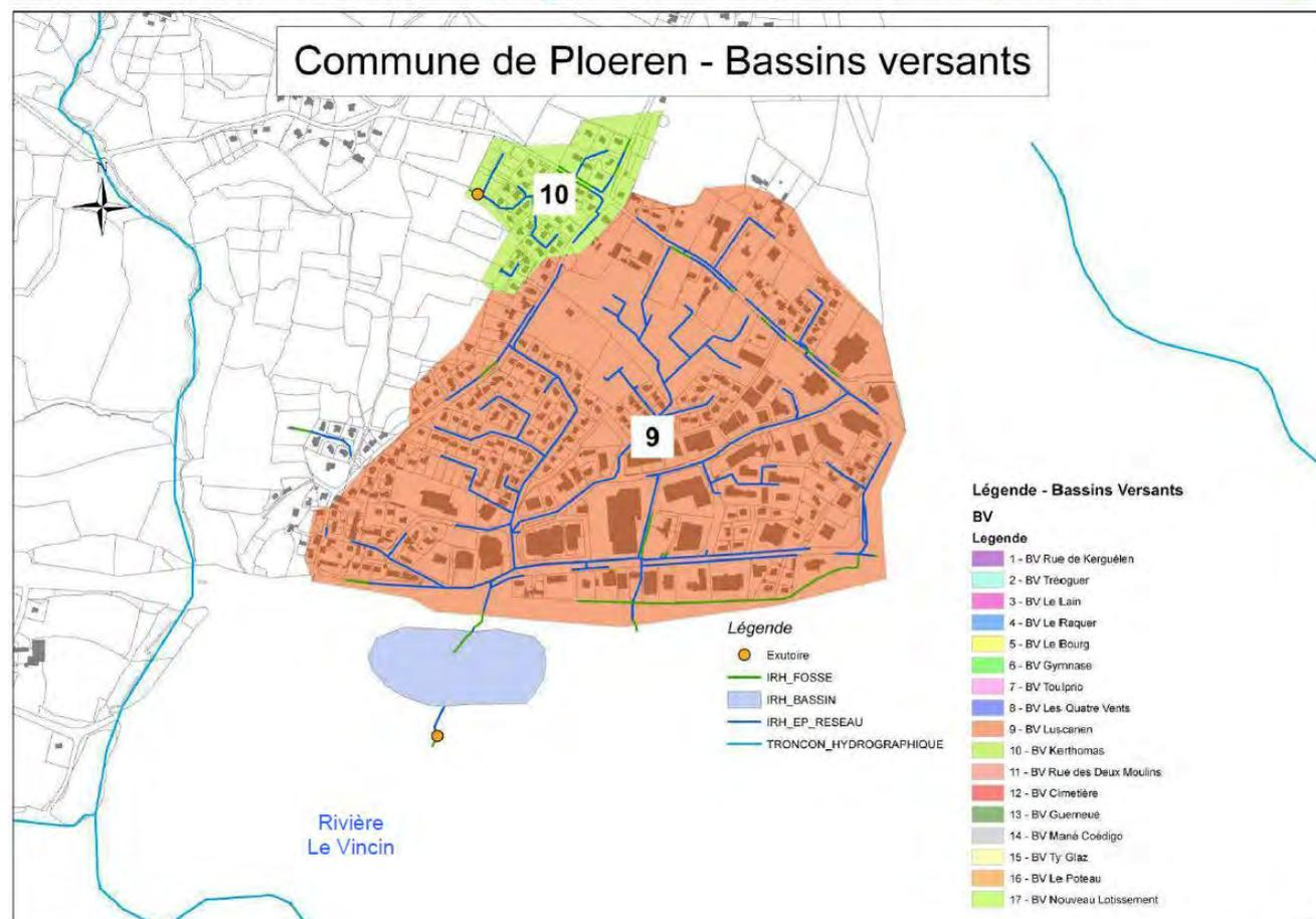
Figure 32- Bassins versants du réseau d'eaux pluviales (IRH, 2012)
